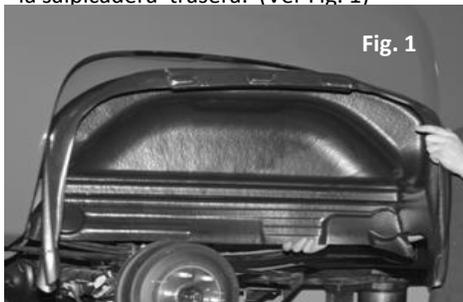
3. Asegúrese de que la parte superior del protector plástico esté colocado detrás de la brida y al rededor del perfil interior de la salpicadera de la carrocería. (Ver fig. 2)
