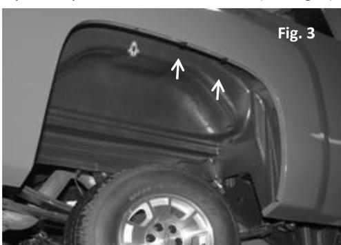
5. Usando un taladro con copa/maneral de 5/16" (7mm) instale un tornillo autorroscante a través de cada uno de los 4 orificios laterales del protector de plástico y la lámina de la salpicadera. (Ver fig. 4 y 5)
