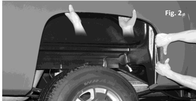
4. Asegúrese que los tres orificios del protector de plástico estén alineados con los orificios de la salpicadera, e instale los clips de presión plásticos a través de ellos (Ver Fig. 3)
